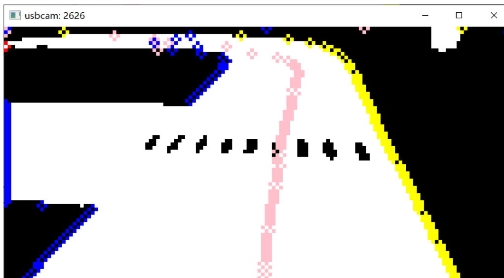
图 5.15 第一次经过车库时的补线
